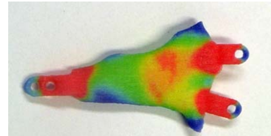
Jochbein, Mock-up mit Spannungsverteilung
